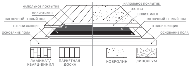
Рисунок 23. Схемы укладки твердых и мягких напольных покрытий.
