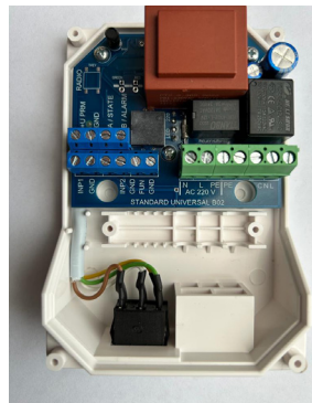
Фото 2. Блок управления GIDROLOCK STANDARD со снятой крышкой
