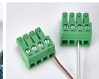
Фото 14. Подключение провода датчика к ответной части разъема
