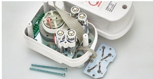
Фото 17. Контактная площадка снята, батарейки могут быть заменены
