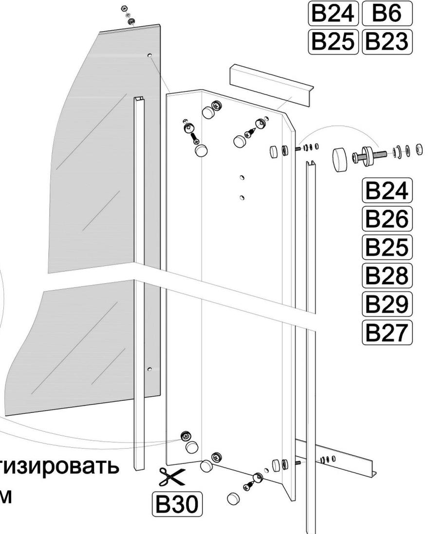
Место примыкания герметизировать нейтральным силиконовым герметиком
