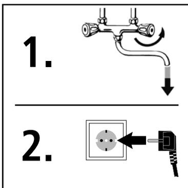
1. Warmwasserventil der Armatur öffnen oder Einhandmischer auf »warm« stellen, bis Wasser blasenfrei austritt.
