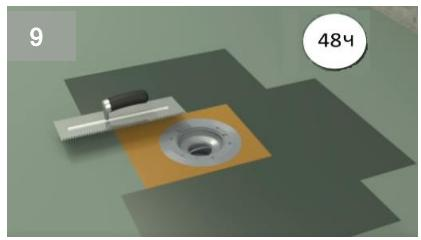
Нанесите второй слой гидроизоляционного поверхностного герметика.
