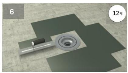
Нанесите первый слой гидроизоляционного поверхностного герметика до уровня карьера решетки.
