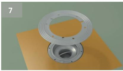
Вставьте изолирующий воротник в жидкий гидроизоляционный герметик.
