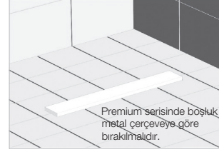
Do not remove the protective styropor until the ceramic application is completed. Seramik uygulaması tamamlanana kadar koruyucu straforu çıkarmayınız.
