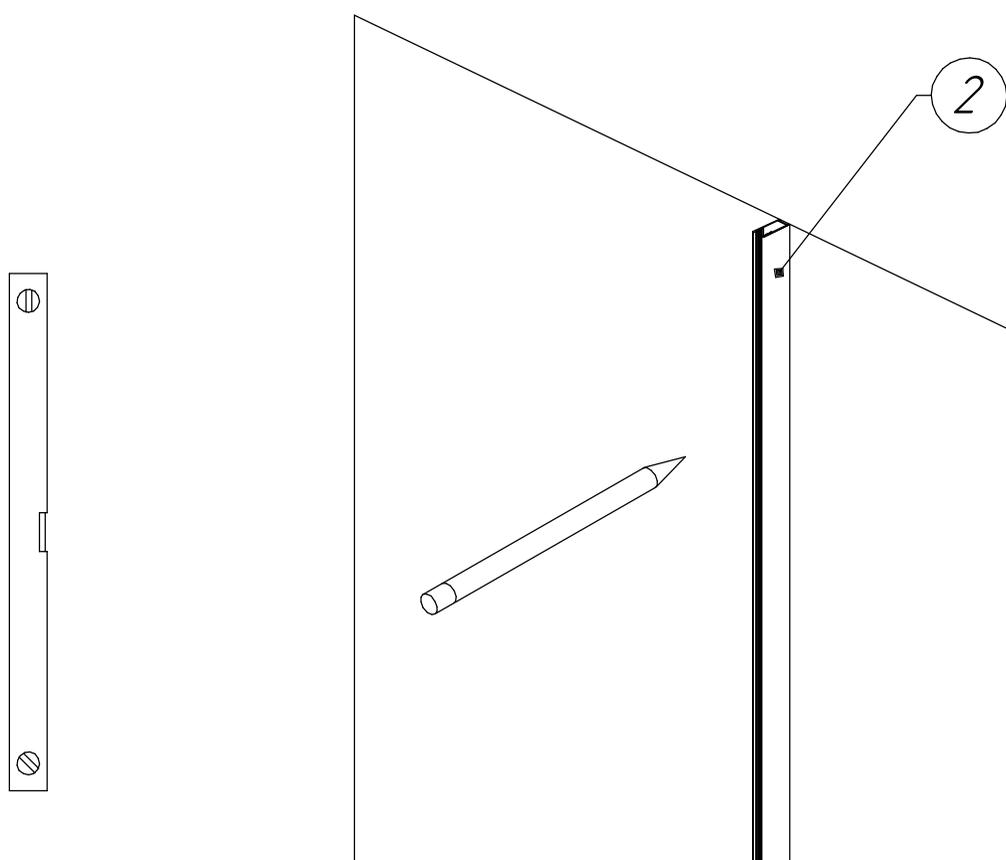
2. Вставьте стекло в профиль ближе к внешней стороне профиля. **Ни в коем случае не забивайте стекло по торцевой части, стекло подвержено при таких ударах к разрушению!** Вставьте с внутренней стороны профиля уплотнитель елочка. Прижмите уплотнитель равномерно по всей плоскости профиля.
