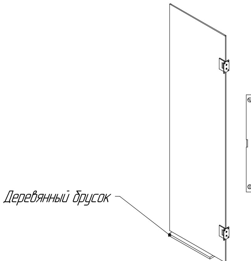
8. Удерживая дверь на месте, отметьте отверстия для обеих петель (16). Просверлите сверлом, вставьте пластиковый дюбель (18) и закрепите при помощи винтов (19) к стене.
