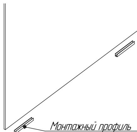
5. Установите стационарное стекло, подложив прокладки, которые идут в комплекте с боковым кронштейном. Прикрепите стационарное стекло к стене с помощью крепежных деталей монтажного кронштейна к навесным деталям с помощью прилагаемых винтов. Установите второе стационарное стекло идентичным образом, подтяните винты боковых кронштейнов. Измерьте расстояние между верхними частями стационарных стекол и между нижними частями, расстояние должно быть **одинаковым**
