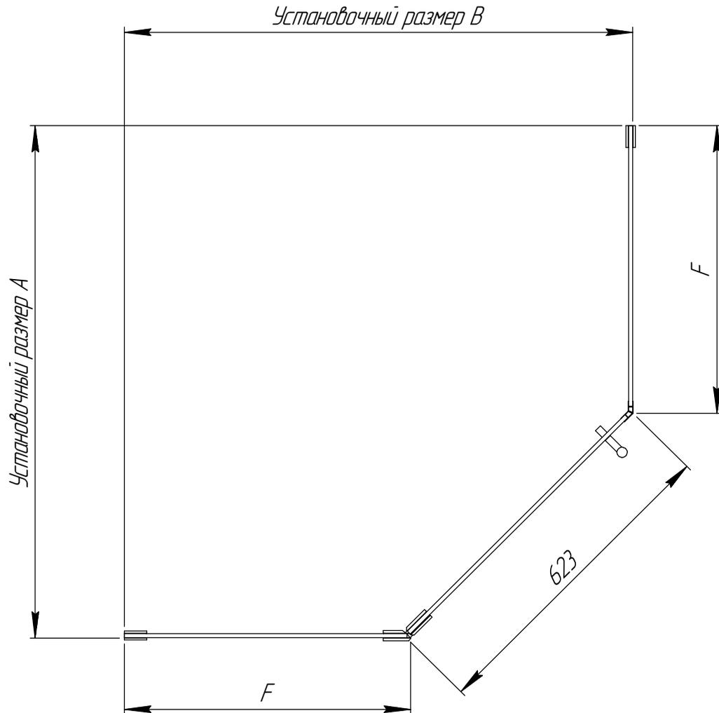
**Установочный размер A/B** является расстоянием от угла помещения до наружной поверхности стационарного стекла. **Размер F** - расстояние от стены до изгиба трапеции. Размер передней части трапеции составляет всегда 623 мм.
