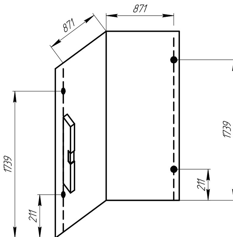
4. Просверлите отверстия необходимого диаметра. Уберите мусор после сверления. Вбейте пластиковый дюбель во все сделанные отверстия. Разберите кронштейн боковой и при помощи самореза закрепите внутреннюю часть кронштейна к стене. Стороной с отверстием к стене, как показано на рисунке.
